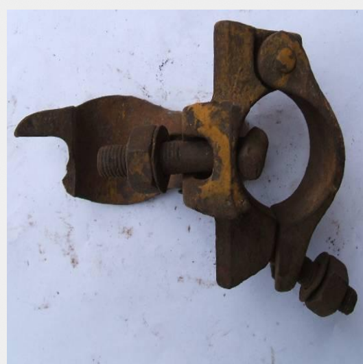
旋转扣件搭板破裂
