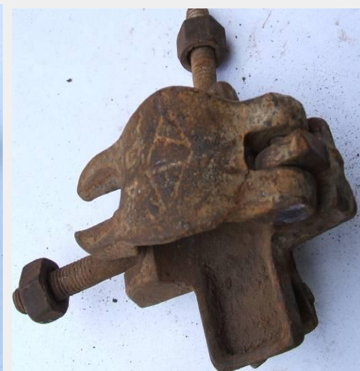
十字扣件搭板有裂缝
