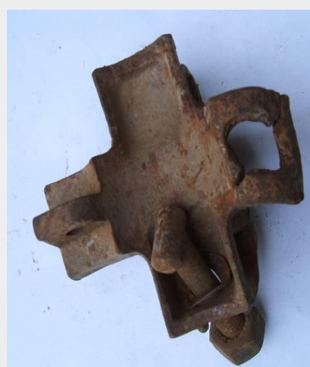
扣件基座损坏
