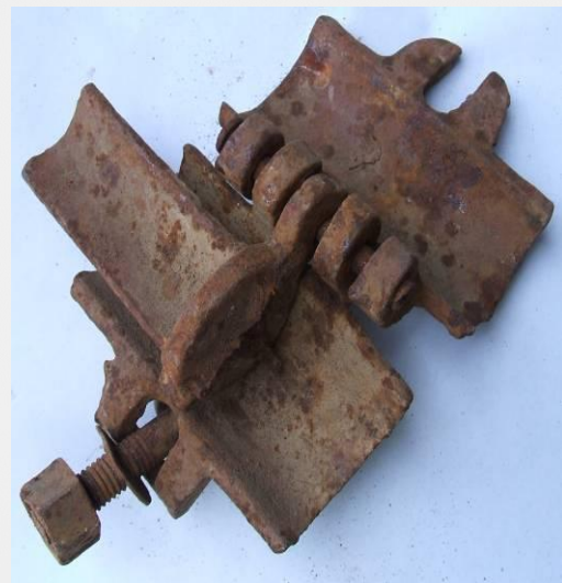
接头扣件芯子断裂
