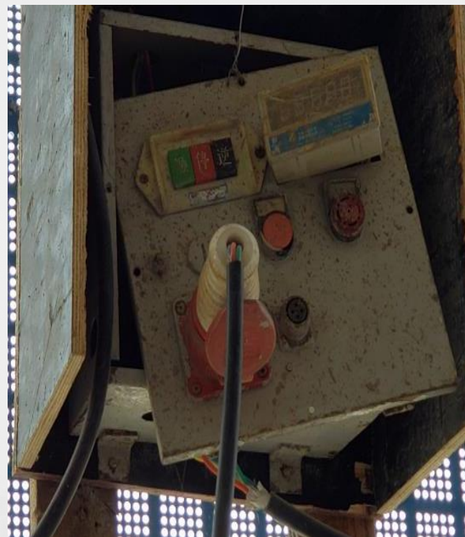
传感器安装位置不合理，同步控制装置损坏
