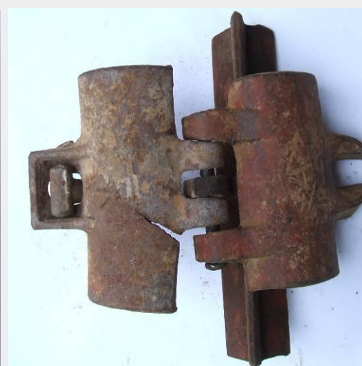
接头扣件搭板损坏
